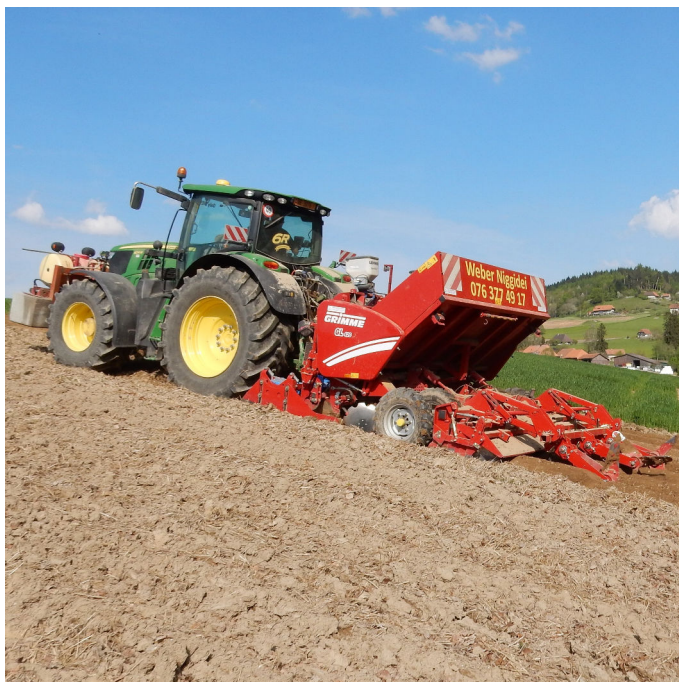
Der Lochstern im Einsatz hinter einem Kartoffelpflanzer GL 420 von Grimme (Tatenda Lemann)
