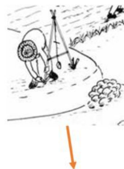
Regla en A para efectuar el trazado de las terrazas
