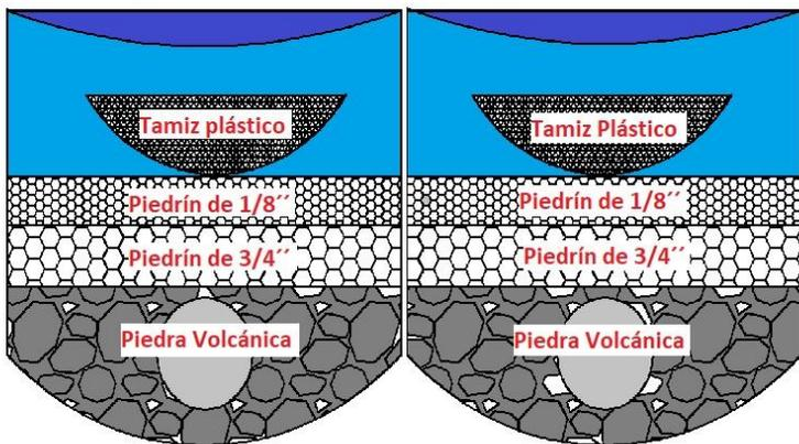
Barril plástico de 200 litros o visitador para reducir la velocidad del flujo de agua en el sistema
