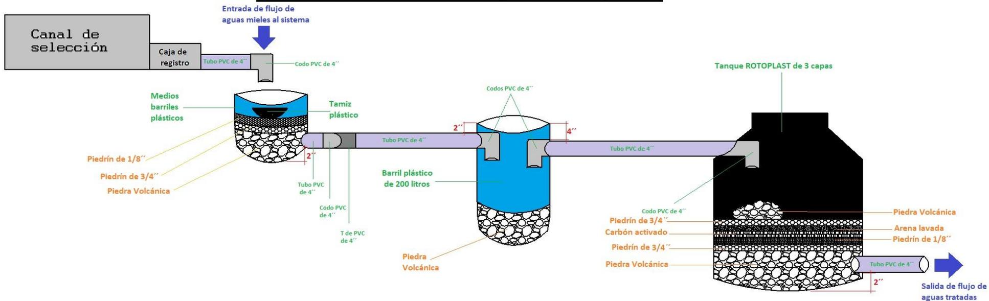
Medios barriles plásticos (Gemelos) con capacidad de 100 litros se colocan paralelamente uno a la par del otro, sus dos salidas de agua se unen con 2 codos PVC de 4" y una T de PVC de 4"
